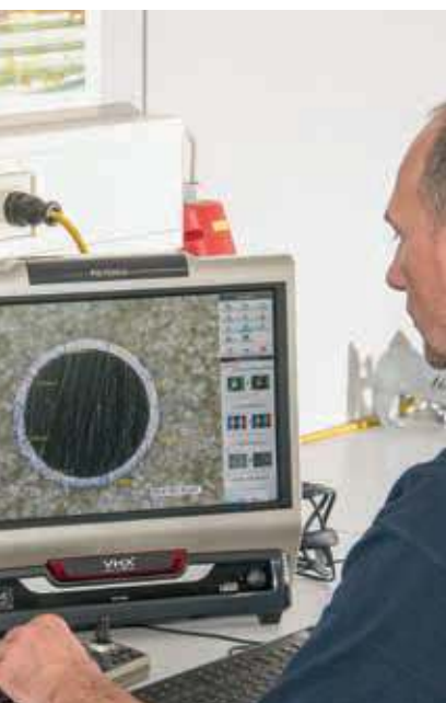
Untersuchung eines Drahtquerschnitts mit digitalem Mikroskop
