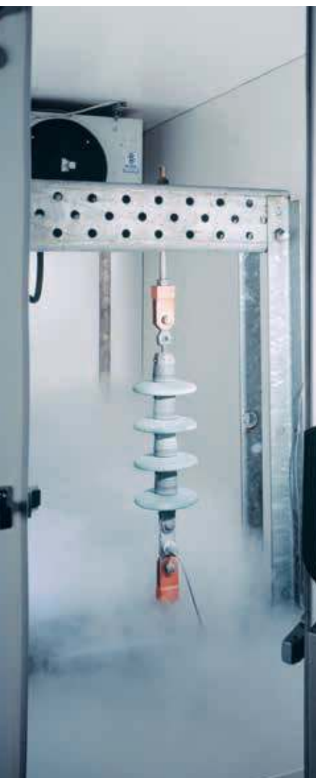
Isolatorenprüfung in Kältekammer
