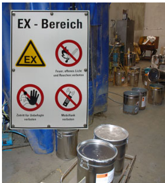
Abb. 5: Beispiel für die Kennzeichnung eines Ex-Bereiches
